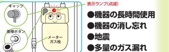
ガスが止まって、赤い表示ランプが点滅していたら、次の復帰の手順にしたがって操作してください。※ガス臭いときは復帰操作は行わず福島ガスまでご連絡ください。
